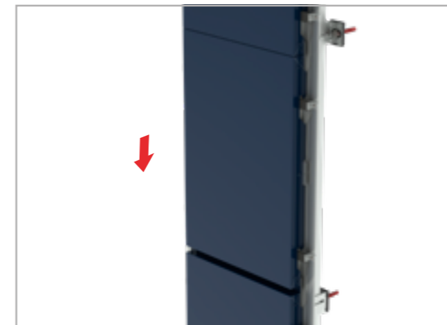
5. Ajuste de la bandeja hasta lograr posición deseada.
