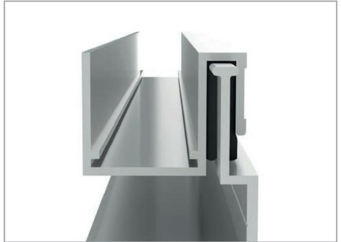
La distance maximum recommandée entre les segments de joint est de 500 mm. L'utilisation de cet accessoire évite d'éventuelles vibrations entre cassettes et permet leur ajustement afin de garantir la planimétrie de la façade.
