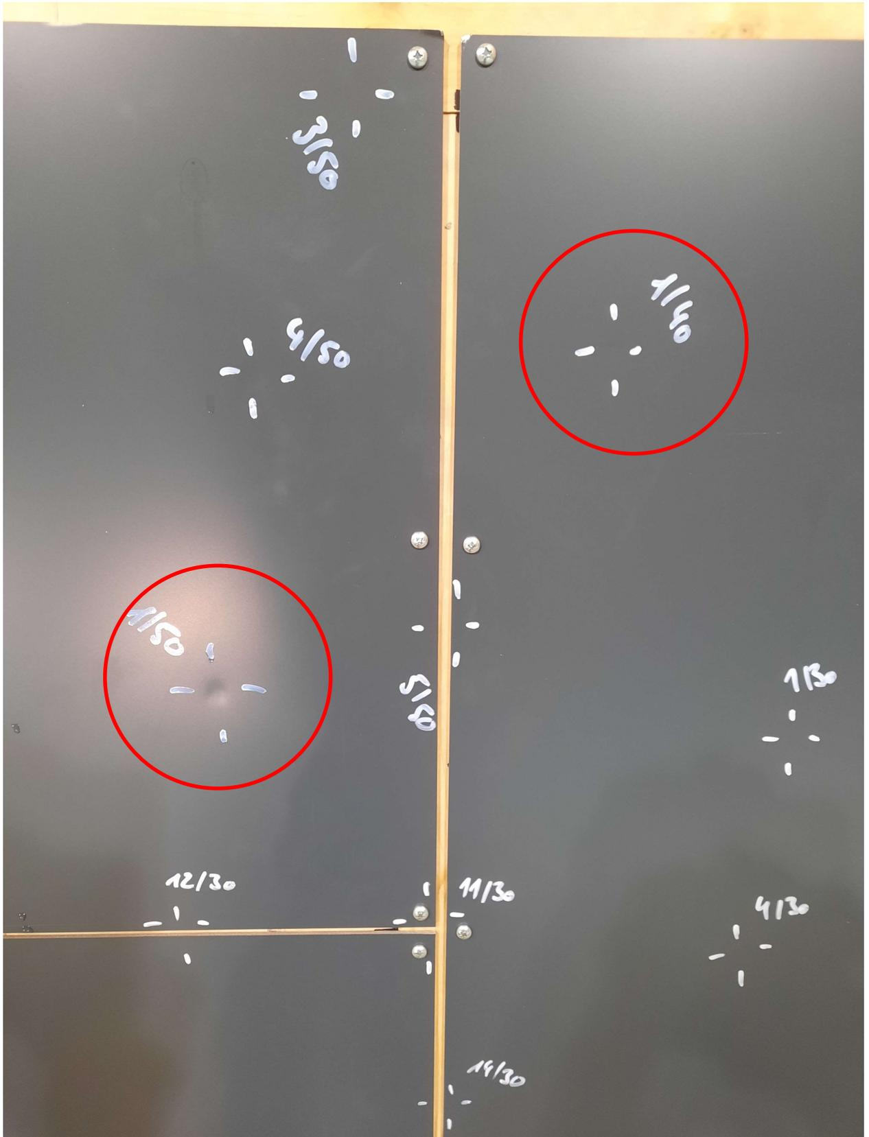
Abb. 3 Sichtbare Dellen nach Beschuss mit 5 cm EK (1/50) und 4 cm EK (1/40)
