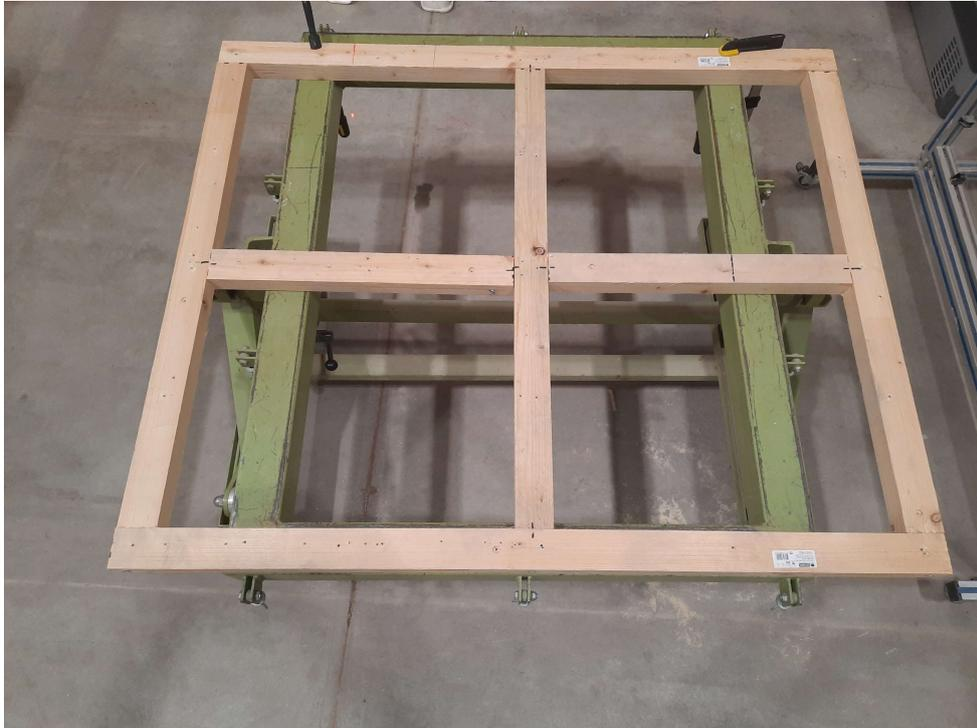
Abb. 1 Unterkonstruktion Holzriegel 60/40 mm
