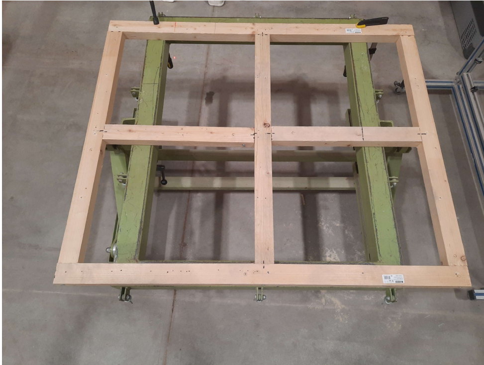
Abb. 1 Unterkonstruktion Holzriegel 60/40 mm
