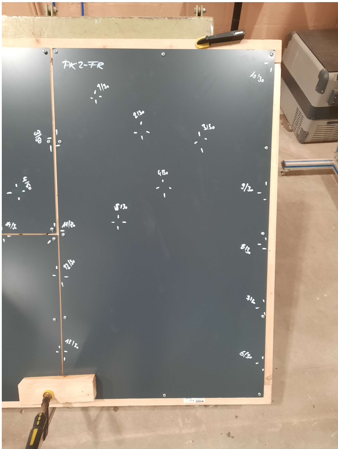
Abb. 4 Keine sichtbaren Dellen nach Beschuss mit 3 cm EK
