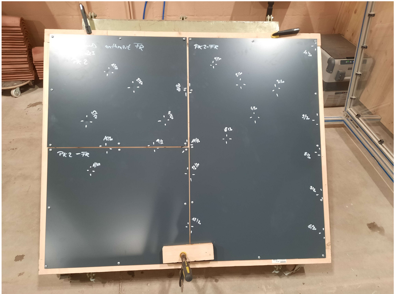
Abb. 2 Prüfkörper 1 Übersicht Beschussorte
