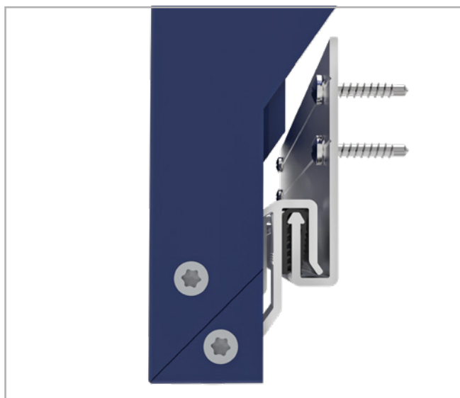
Position der Z- und S-WINKEL an der geformten Kassette.
