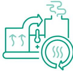
El aire de salida del proceso de combustión está canalizado a través de un oxidador térmico regenerativo RTO (Regenerative Thermal Oxidizer), donde se depuran gases contaminados con compuestos orgánicos volátiles y sustancias oxidables a alta temperatura.
